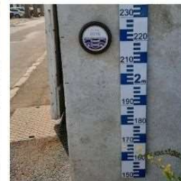
Laisse de crue
